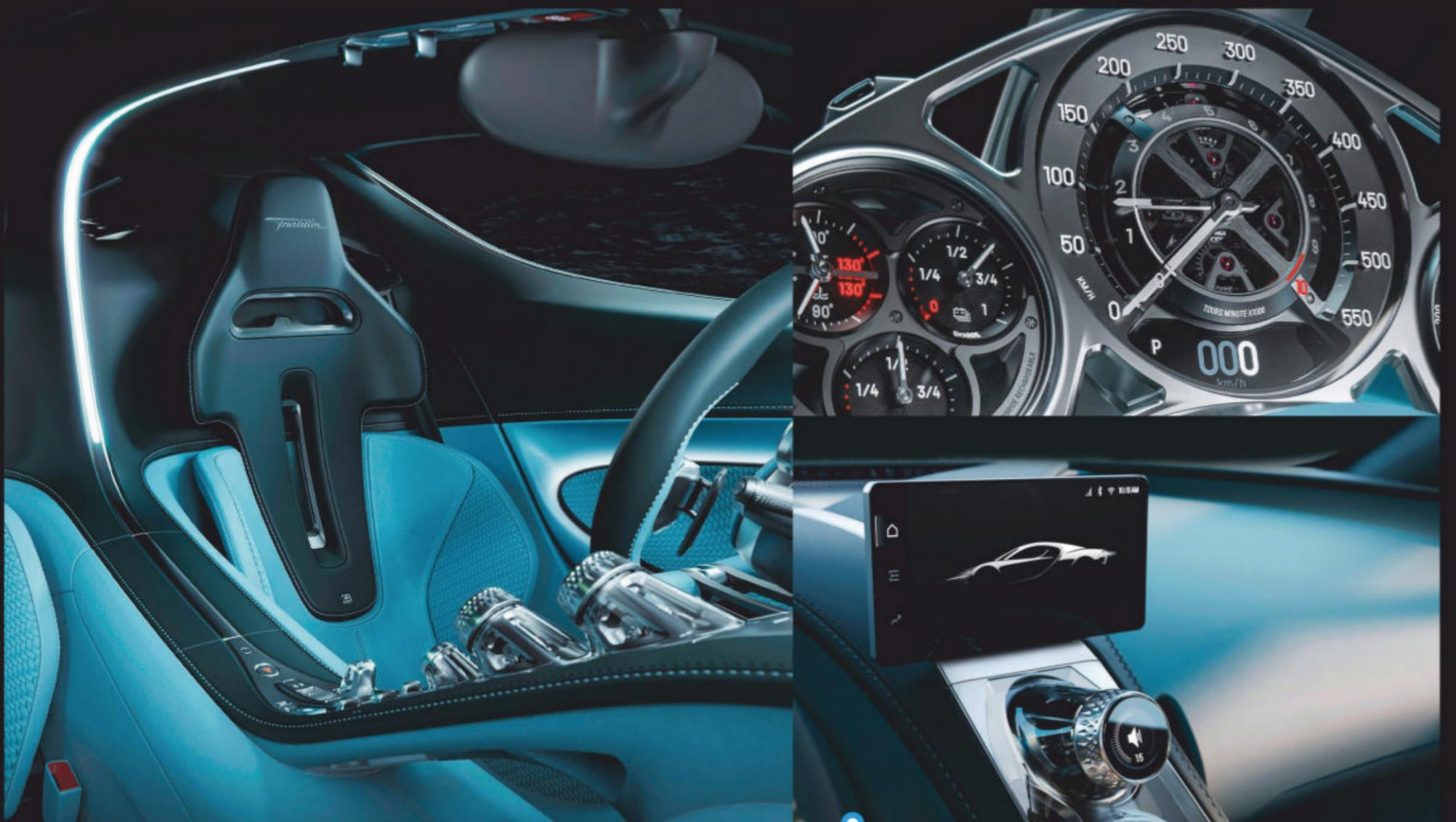
Le soin du détail atteint un niveau inouï. Le bloc compteurs, ouvragé par des horlogers suisses comme une montre squelette, est un chef-d'œuvre à lui seul. Dissimulé sous la console centrale, ajourée de cristal pour mettre en scène ses mécanismes, un petit écran peut surgir à la demande.
